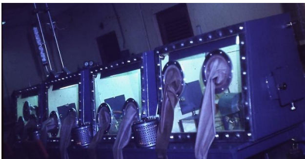
Figura. 2: Cajas de guantes para la fabricación de transistores de germanio en atmosfera controlada totalmente construidas en la Escuela de Física, UH, 1968
